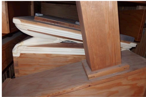
Figur 14. Skinnen har släppt i bälgen pga det höga oreglerade lufttrycket.
