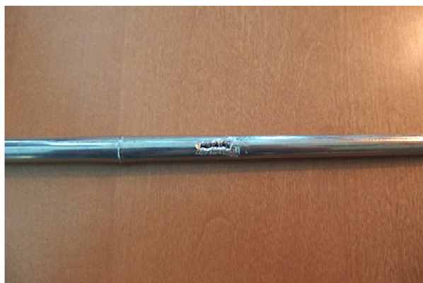
Figur 17. Möss har gnagt hål på en metallpipa.
