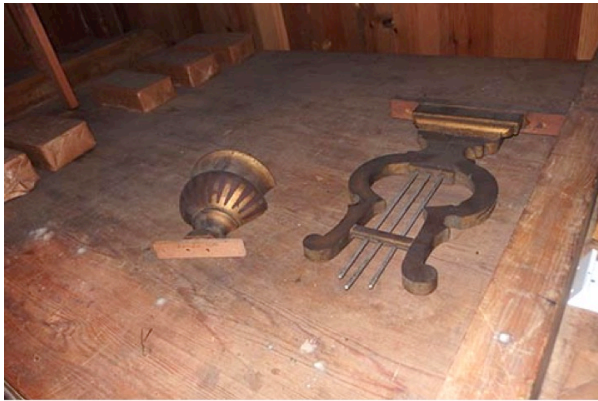
Figur 26. Tyngden av de inslagna tegelstenarna till vänster på bälgen ger önskat lufttryck medan de övriga föremålen ger ett förhöjt lufttryck.
