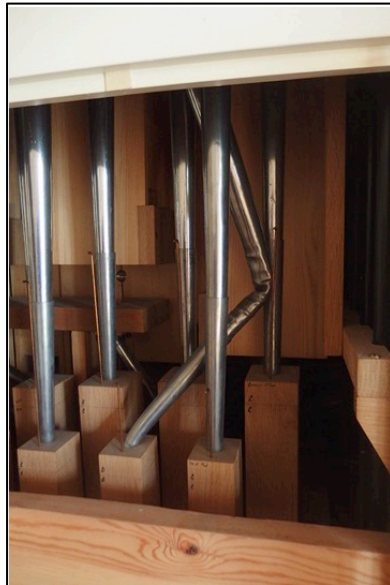
Figur 8. Uppsats nedre del deformerad.
