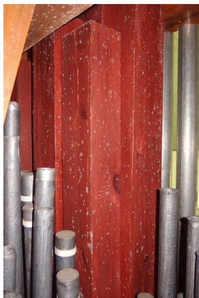
Figur 16. Mögelfläckar på träpipor.
