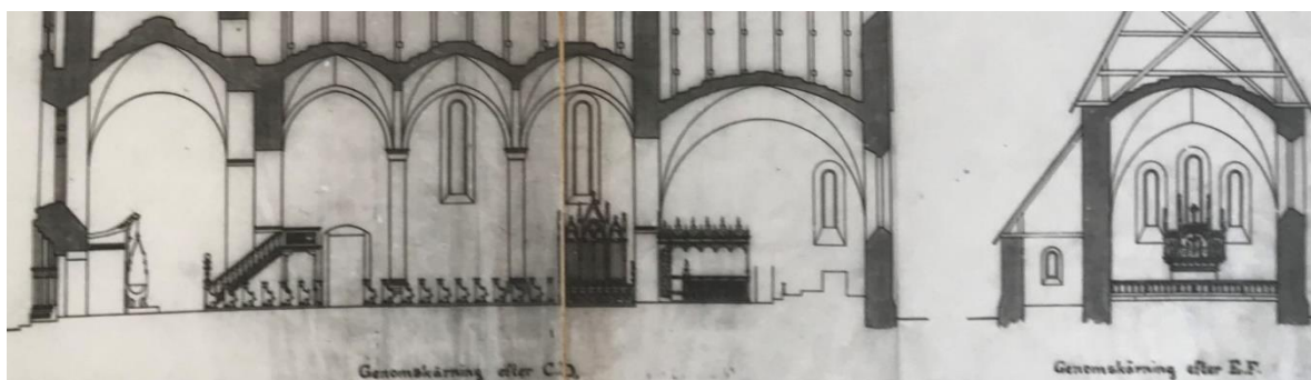
Ritningar från 1899, till kyrkans restaurering. Avsikten var att byta bänkkvarteren mot öppna bänkar och bygga två mindre läktare. Kaminernas inbilade rökrör markerade Kulturhistoriska byråns ritningsfoton, ATA (D11:4-5).
