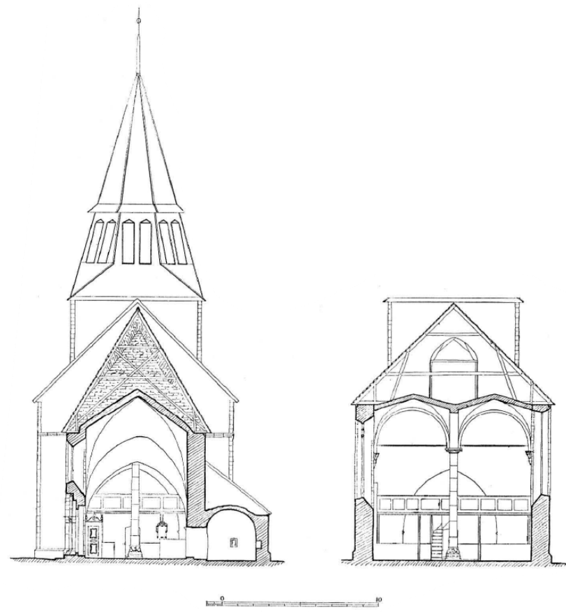
Tvärsektion genom kor och sakristia mot väster och genom långhuset mot väster samt längdsektion mot söder. Uppmätning av Sten Wennerström och Adolf Niklasson 1921, kompletterad 1934. Efter SvK (42), Gotland II (1935).
